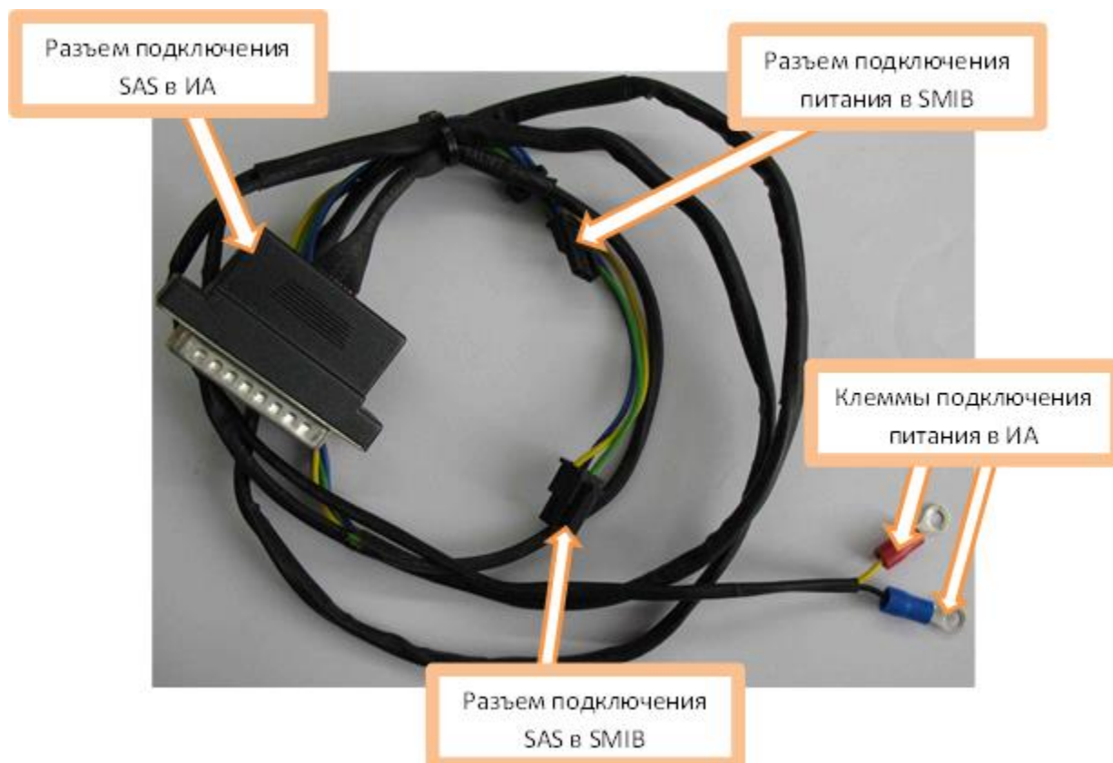
Рисунок 3.4.3 – Кабель соединительный РуI 25-02
