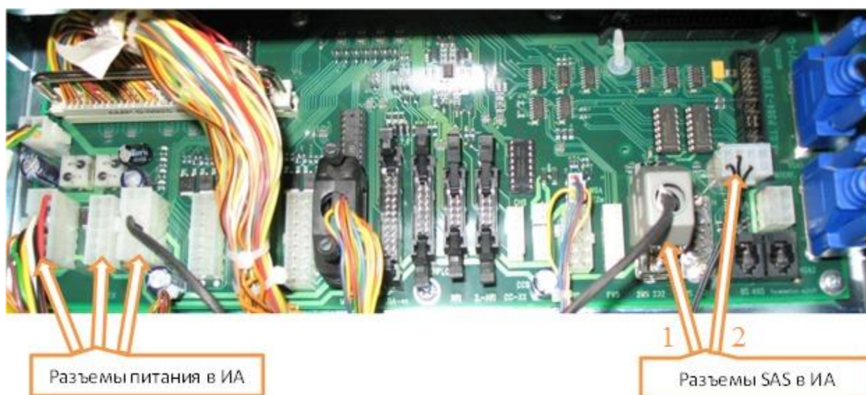
Рисунок 3.4.1 – переходная плата ИА.
