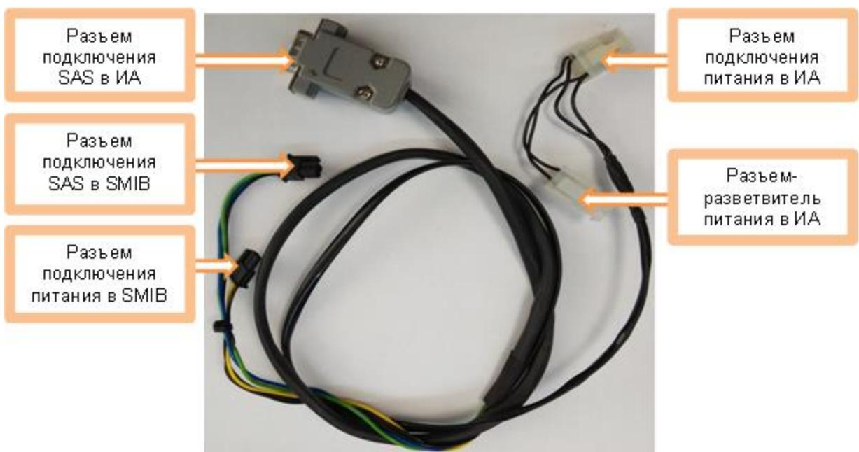
Рисунок 3.4.2 – Кабель соединительный RuI 09M-06
