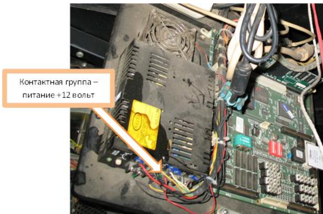
Рисунок 3.4.2 – Подключение питания в ИА
