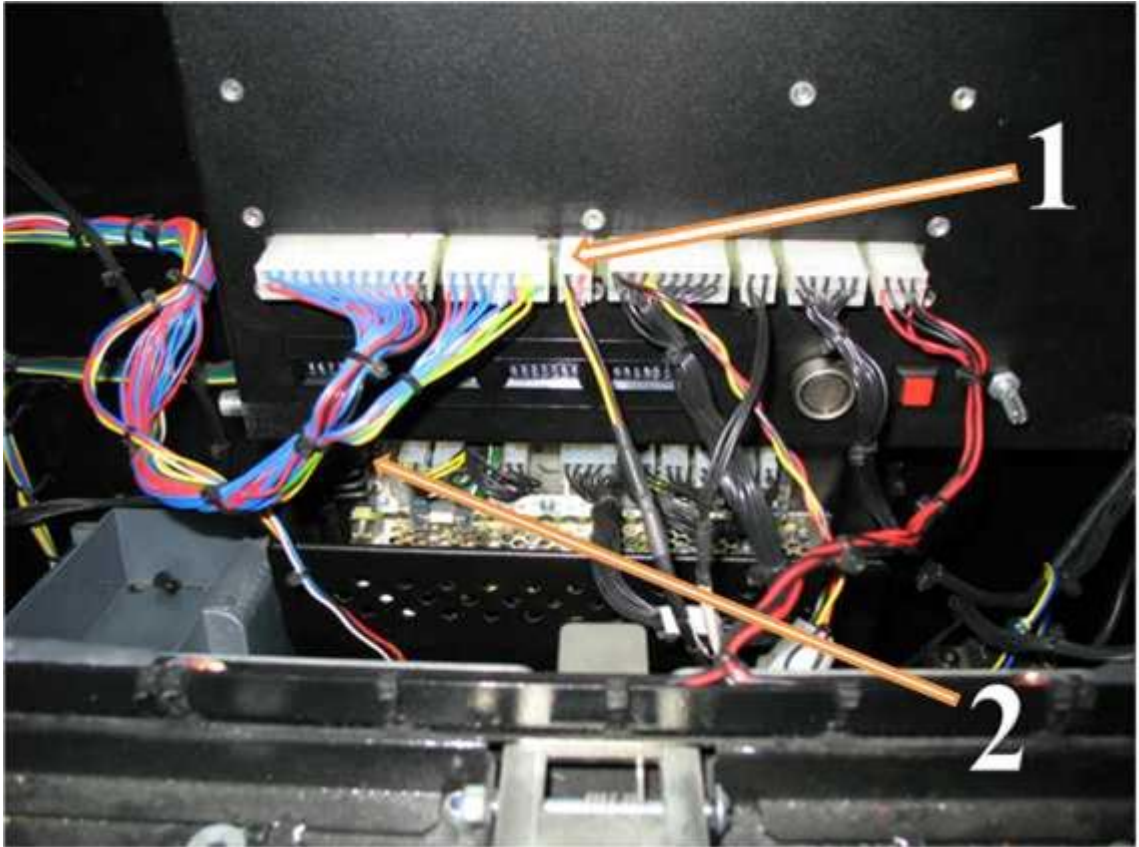
Рисунок 3.3.2 – Подключение кабеля SAS (1) и кабеля питания (2)
