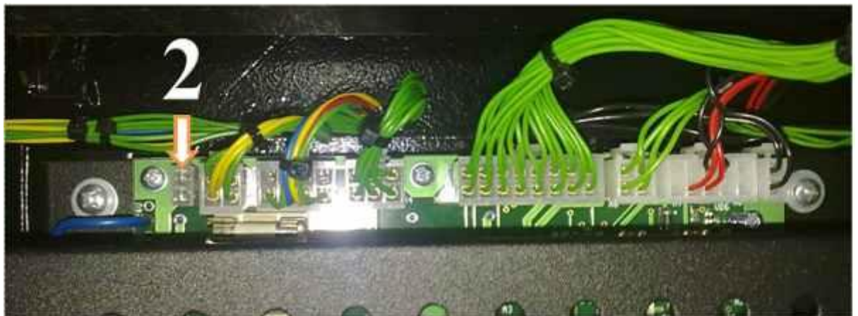
Рисунок 3.3.3 – Подключение кабеля питания (2)
