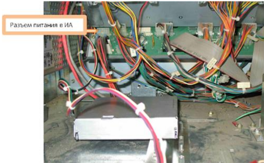
Рисунок 3.4.1 – Подключение питания в ИА.
