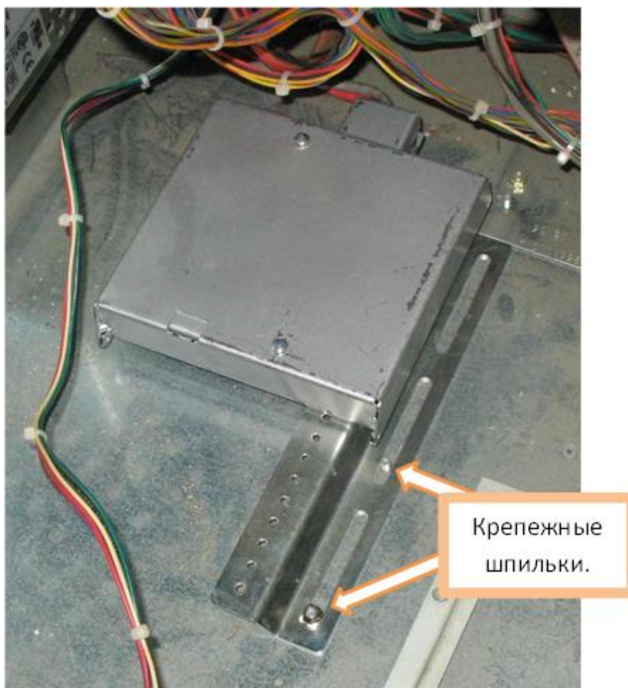
Рисунок 3.3.1 – Закреплённый КИА в ИА
